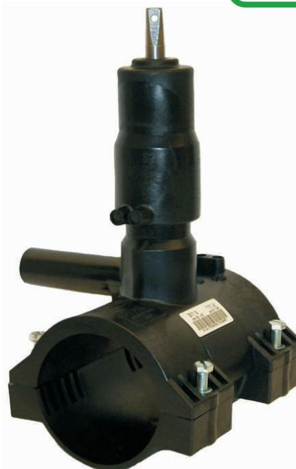
Verschweißbar ist die Armatur mit Rohren der Wanddickenverhältnisse SDR 11, SDR 17 und SDR 17,6 aus den Werkstoffen PE-80, PE-100 und PE-Xa. Die Armatur muss vor der Anbohrung einer Druckprobe unterzogen werden. Die Armatur kann auf Wunsch mit integriertem Gasströmungswächter G 100 geliefert werden. Bitte bei Bestellung gesondert angeben.
